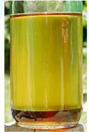
Fig. 1. Apariencia del biodiesel durante la agitación y una vez separado
