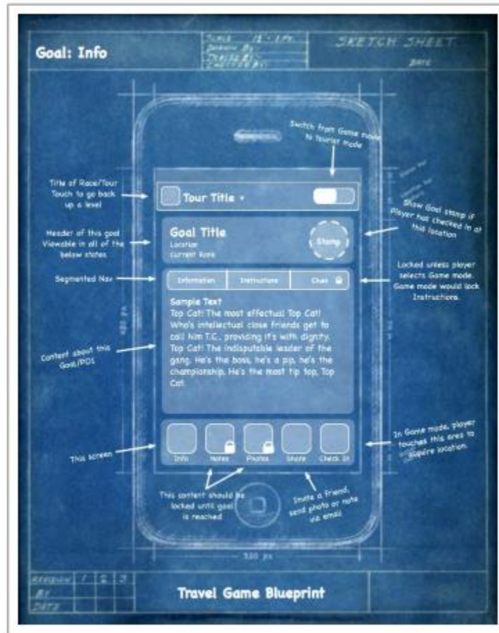
Figura 3. 3. El uso de un wireframe de baja fidelidad para definir el elemento de la disposición de diseño antes del diseño visual (Brian, 2009)
